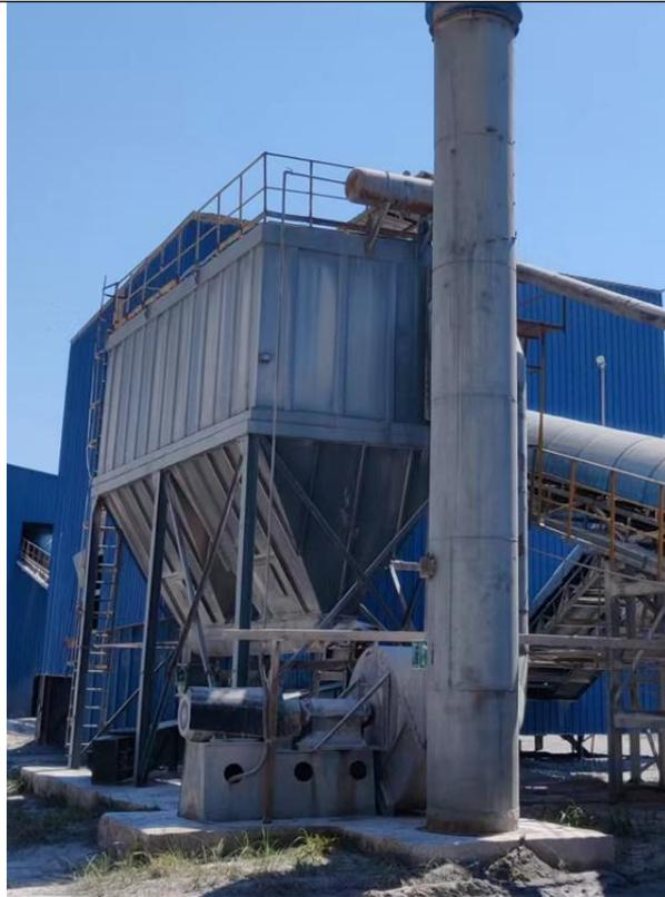
建筑用白云质岩破碎站除尘器
